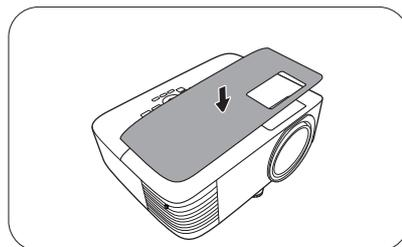
13. Apriete el tornillo que sujeta la cubierta de la lámpara.
