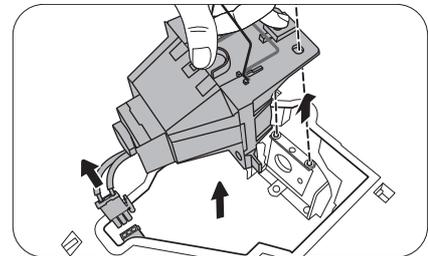
8. Como se muestra en la figura, inserte la lámpara nueva. Alinee el conector de la lámpara y los dos puntos afilados con el proyector, para después empujar la lámpara ligeramente hacia la posición de bloqueo.
