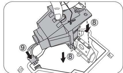
10. Apriete los tornillos que sujetan la lámpara.
