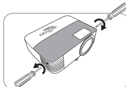
3. Retire la cubierta de la lámpara del proyector.
